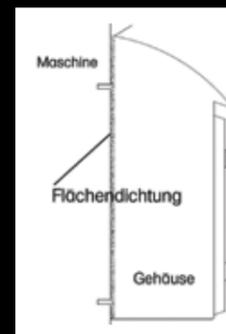
MASCHINENMONTAGE MIT FLÄCHENDICHTUNG ODER T-ROHR
